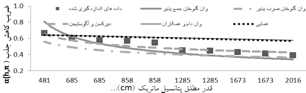
شکل ۱۰- برازش مدل‌های مختلف برداده‌های اندازه‌گیری شده حاصل از تیمار سطح شوری ۴/۵ dS/m و تخلیه ۶۰ درصد
