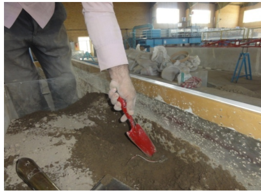
شکل ۲- نمایی از نقاط اندازه‌گیری نیترات در هر محفظه و نمایی از نمونه برداری خاک در نقاط مشخص شده پس از انجام آزمایش.
