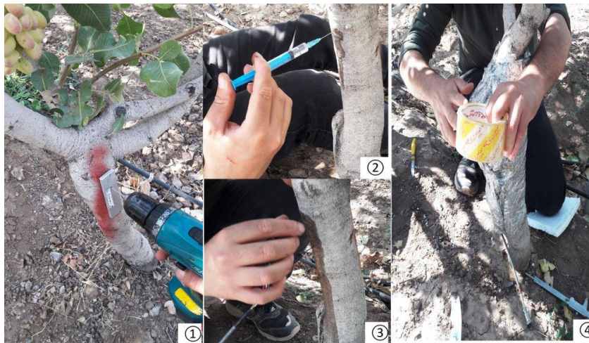
شکل ۲- مراحل نصب سنجدده دستگاه اندازه‌گیری شیره آوندی
