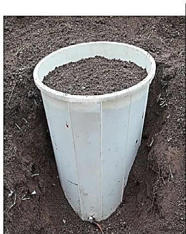
شکل ۱- تصویری از مینی لایسیمتر استفاده شده در پژوهش و موازنه آب در واحد حجم خاک (آلن و همکاران، ۱۹۹۸)
