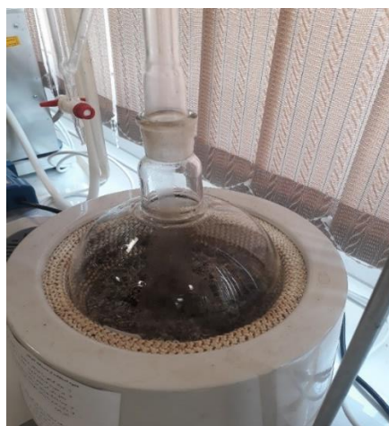
شکل ۱- اسانس‌گیری مریم‌گلی با دستگاه کلونجر
